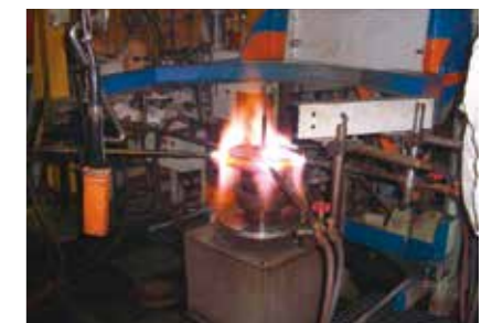
大型焼入機使用によるギヤの火炎焼入
